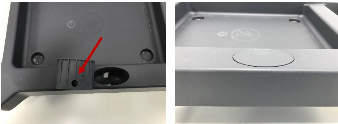
**Шаг 4.** Вставить рукоятку в стойку транспортировочной ручки таким образом, чтобы бы технологические отверстия совпали.
